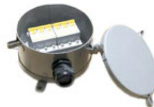
Применяется при монтаже системы охлаждения трансформатора. Предназначена для подключения электродвигателей охлаждения к питающей магистрали. Установленные в коробке автоматические выключатели защищают электродвигатели обдува от возможного короткого замыкания.
